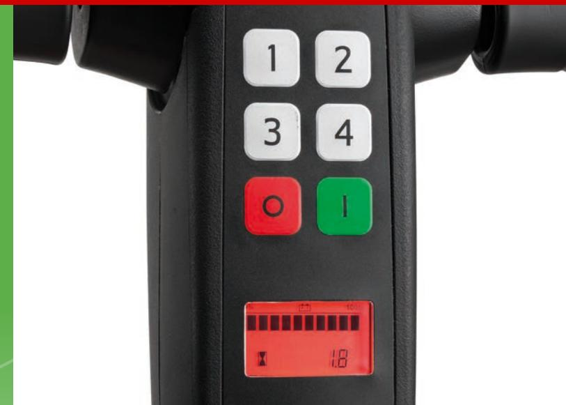
Ergonomischer Deichselkopf für eine sichere und präzise Handhabung. Schleichgeschwindigkeit für optimale Manövrierfähigkeit und Sicherheit. PIN-Code beugt unbefugte Benutzung vor und kein Risiko von verlorenen Schlüsseln
