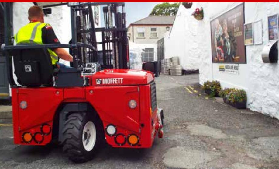
Das Modell M2 ist auf Hubkapazitäten von 1.500 bis 1.700 kg ausgelegt. Es eignet sich für eine Vielzahl industrieller und gewerblicher Anwendungen. Der MOFFETT M2 ist mit umfassenden Standardfunktionen ausgestattet und bietet ein Maximum an Betriebssicherheit beim Ladungsumschlag im dichten Stadtverkehr.
