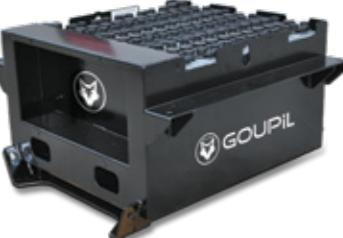
3 Traktions-Batteriepacks (8,6 kWh, 11,5 kWh, 15,4 kWh) und 2 Lithium-Batteriepacks mit 9 kWh oder 13,8 kWh Leistung. Jede dieser Batterievarianten kann über eine Haushaltssteckdose geladen werden (230 V). Die Lithium-Batterien bieten darüber hinaus die Möglichkeit der Zwischenladung und sind komplett wartungsfrei.
