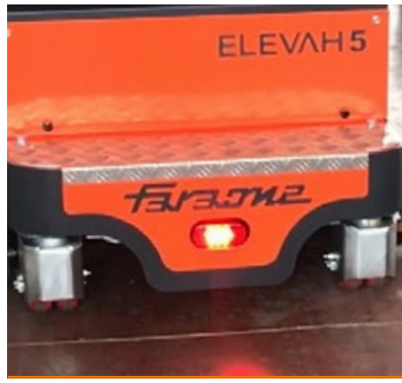
E5BLMA Elektrischer Richtungsblock, der in der Höhe betrieben werden kann. Doppel Lenkräder mit Anti-Zerquetschen.
