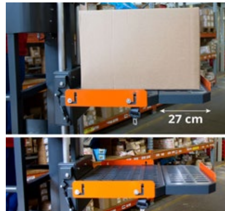
PMF Abnehmbare Erweiterung der Picking-Plattform (für elektrische Kommissionierplattform).
