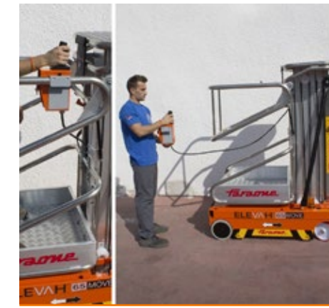
CA Abnehmbare Steuerung mit zusätzlichen 150cm Kabel.
