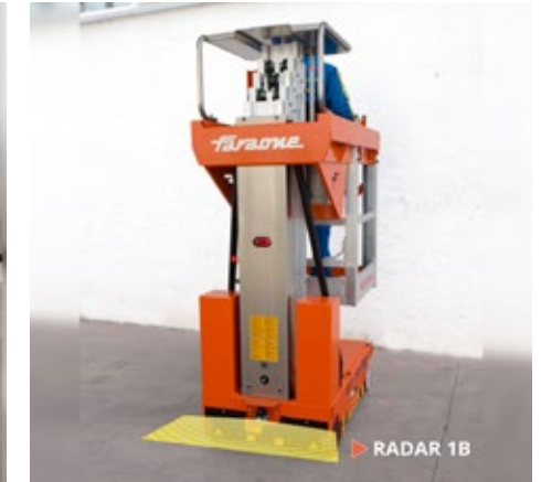
RADAR1B Hinteres Antikollisions Radar für den Chassis.
