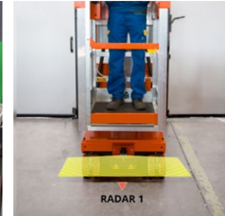
RADAR1 Vorderes Antikollisions Radar für den Chassis.
