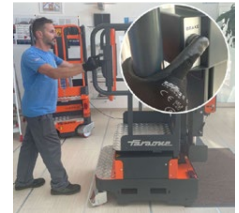
E5MAN Manuelles Lösen der automatischen elektronischen Feststellbremse. Ermöglicht das manuelle Bewegen der selbstfahrenden Maschine.
