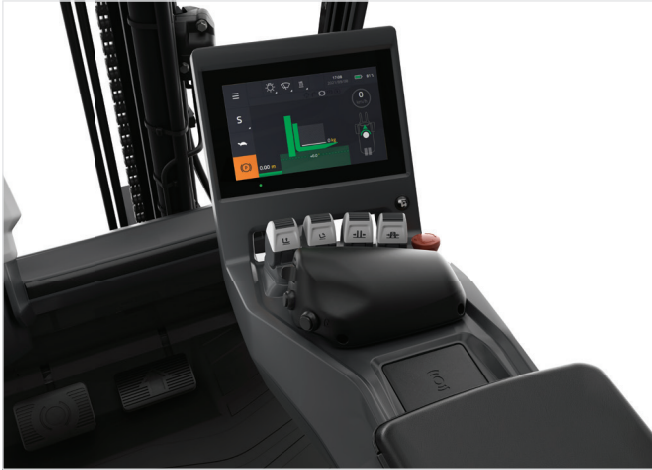
Die Anzeige- und Hebeloptionen wurden mit Blick auf den Bediener entwickelt, um optimalen Komfort und Produktivität zu gewährleisten. Das Farb-Touchscreen-Display ist sowohl intuitiv als auch interaktiv und zeigt die wichtigsten Parameter und Bedienelemente an.
