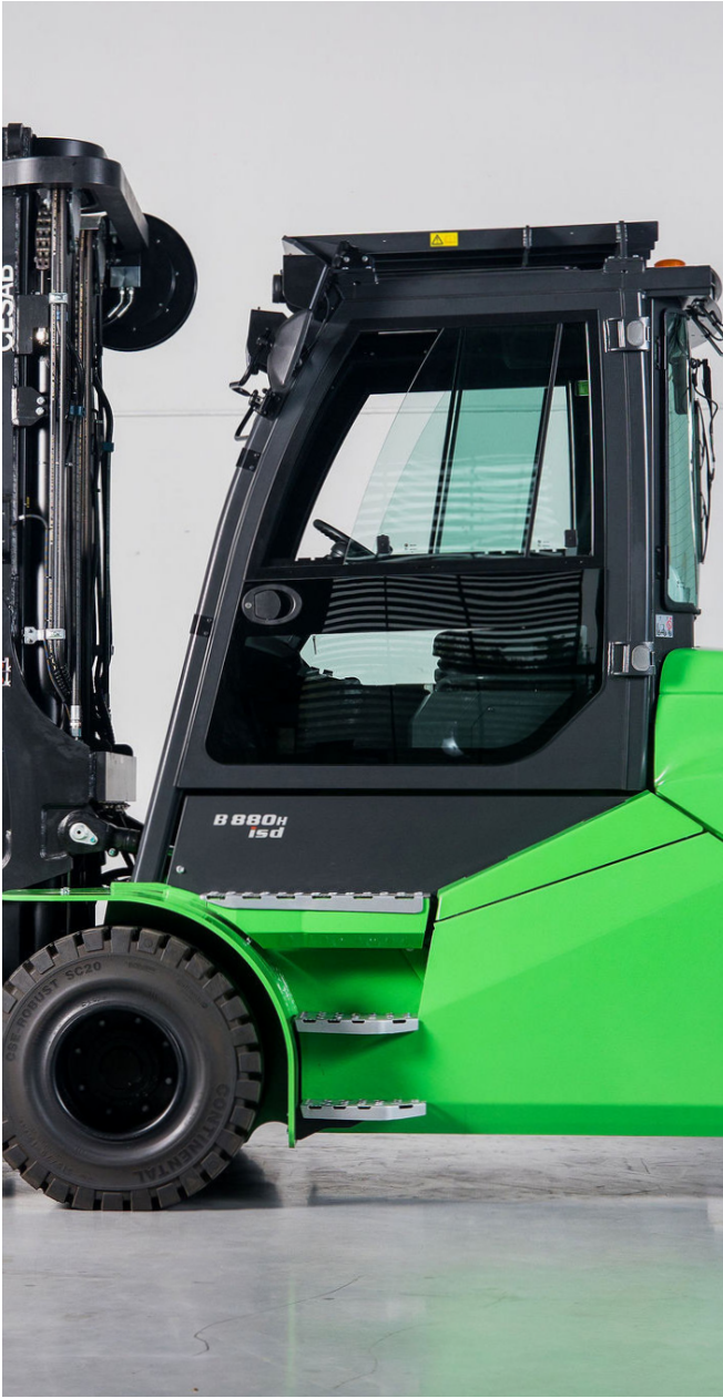
Die geräumige, schwimmend gelagerte Fahrerkabine mit minimalen Vibrationen und geringer Geräuschentwicklung bietet dem Fahrer einen komfortablen Arbeitsplatz.
