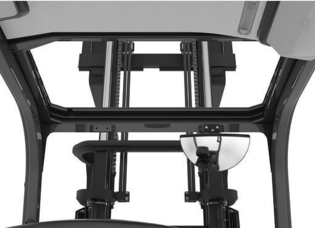
Freie Sicht auf die Gabelspitzen durch alle Hubgerüste, transparentes Glasdach (optional) ermöglicht sichere und effiziente Umschlagarbeiten und erhöht den Komfort und die Produktivität des Fahrers.
