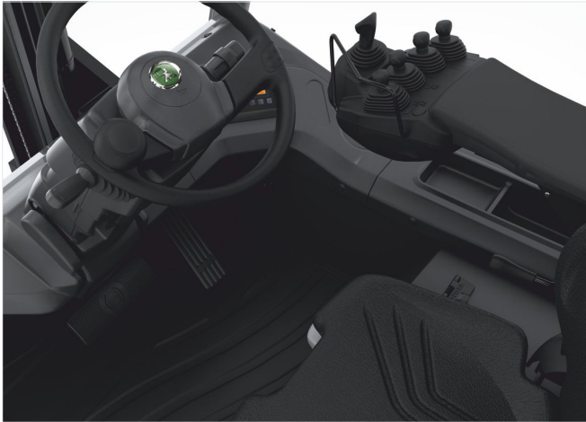
Die geräumige, schwimmend gelagerte Fahrerkabine mit minimalen Vibrationen und geringer Geräuschentwicklung bietet dem Fahrer einen komfortablen Arbeitsplatz.
