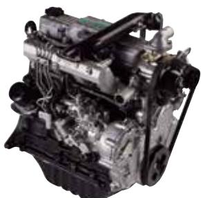
Der 1DZIII-Dieselmotor ist in den Diesel-Drehmomentwandlerversionen für 1,5 und 1,8 Tonnen verfügbar
