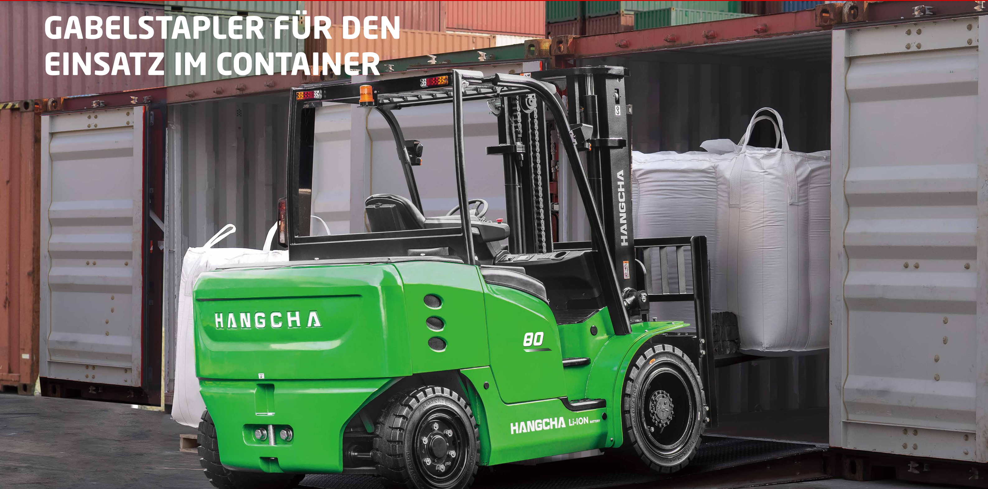
Gabelstapler der X-Serie mit Lithium-Ionen-Batterie für den Einsatz im Container
