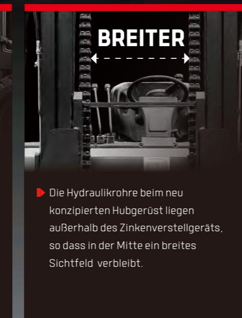
► Die Hydraulikrohre beim neu konzipierten Hubgerüst liegen außerhalb des Zinkenverstellgeräts, so dass in der Mitte ein breites Sichtfeld verbleibt.
