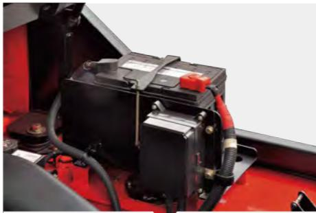
► Alle Steuerungen, Relais und Sicherungen sind in der Steuerbox frei von Wasser und Staub angeordnet. Die wichtigsten elektronischen Komponenten sind wasserdicht und können in rauen Umgebungen eingesetzt werden. Und der berühmte Markenluftfilter wird auch im unseren Gabelstaplern eingesetzt.
