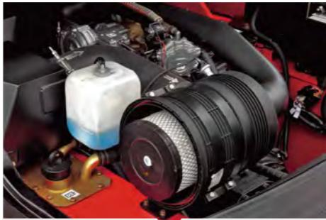
► Der neue Luftfilter verfügt über einen tangentialen Lufteinlass und eine doppelte Abdichtung mit Sicherheitsfilter. Er ist langlebig, nicht korrosiv und vibrationsfrei. Im Vergleich zu früheren Produkten weist er eine höhere Filtrationseffizienz und einen geringeren Luftansaugwiderstand auf.
