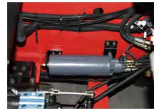
Im Bremssystem befindet sich ein Energiespeicher. Wenn der Motor abgestellt ist, kann er auch mehr als die vierfache Notbremsekraft liefern.
