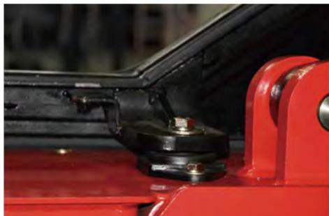
► Es gibt vier Stufen der Stoßdämpfungsfunktion, mit denen die Vibrationen von der Straße zum Fahrer reduziert werden können. Das angebrachte stoßdämpfende Pad kann die Vibration zwischen verschiedenen Teilen der Karosserie verringern. Der gefederte Sitz ist eine weitere Möglichkeit, Vibrationen zu reduzieren.
