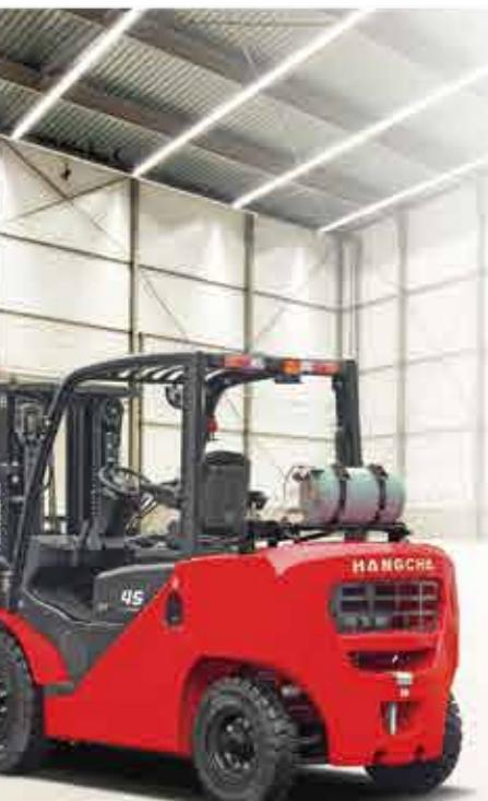
Bei der Entwicklung der neuen XF-Serie werden Komfort und Benutzerfreundlichkeit sorgfältig berücksichtigt, um beispielsweise die Vibrationspegel zu verbessern, werden Verbundmotordämpfer und voll schwimmender Antriebsstrang eingesetzt.
