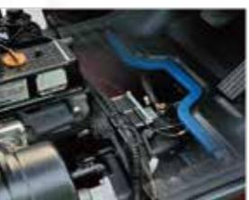
Neben dem Gummidämpfer zwischen Rahmen und Lenkachse erreichen der Verbundmotordämpfer und der vollschwimmende Antriebsstrang eine flexible Verbindung zwischen Rahmen und Antriebssystem, wodurch Fahrvibrationen des Antriebssystems erheblich reduziert werden.
