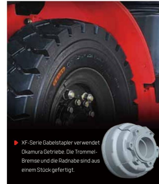
► XF-Serie Gabelstapler verwendet Okamura Getriebe. Die Trommel-Bremse und die Radnabe sind aus einem Stück gefertigt.
