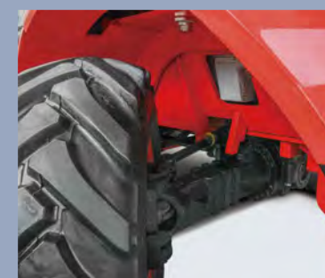
Die pendelnde Lenkachse hält das Fahrzeug auch beim Überfahren von Hindernissen im Gleichgewicht.
