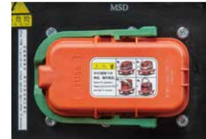
Sowohl Batterie als auch Kabelkasten besitzen einen Wartungsschalter zum Abschalten auf Knopfdruck.
