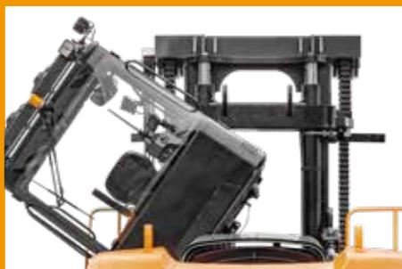
Kabine durch elektrischen Zylinder hochklappbar.
