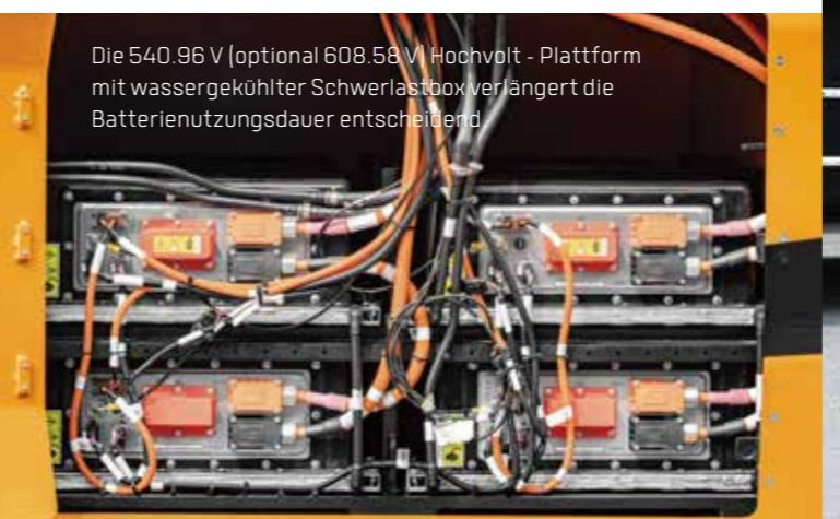
Die 540.96 V (optional 608.58 V) Hochvolt - Plattform mit wassergekühlter Schwerlastbox verlängert die Batterienutzungsdauer entscheidend.
