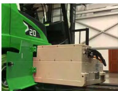
Der Batteriepack ist auf Rollen gelagert und lässt sich einfach auf einen Hubwagen ziehen für Wartung oder Wechsel.
