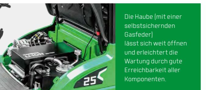
Die Haube (mit einer selbstsichernden Gasfeder) lässt sich weit öffnen und erleichtert die Wartung durch gute Erreichbarkeit aller Komponenten.
