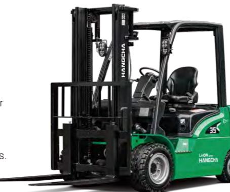
Das ergonomisch gestaltete Lenkrad mit kleinem Durchmesser kann in der Neigung eingestellt werden und liegt jederzeit bequem in der Hand. Der Fahrersitz lässt sich 210 mm nach vorne- und zurückziehen, so dass jeder Fahrer seine optimale Fahrposition selbst einstellen kann.
