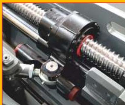
Das Variable Reach System (VRS), ein preisgekröntes und patentiertes Ausfahrwerk für den Hubmast, bietet Präzision, Geschwindigkeit und reduzierte Wartungskosten. Der Mastausschub, der in der aktuellen Generation über zwei Archimedes-Spindeln und zwei zusätzliche Linearführungen geführt wird, ermöglicht das präzise Positionieren der Last auch in großer Arbeitshöhe. Diese fortschrittliche Technologie trägt dazu bei, die Sicherheit beim Umgang mit langen Ladegütern zu erhöhen.
