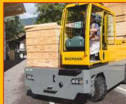
Die hydraulisch kontrollierten Pendelachsen gleichen permanent Unebenheiten auf den Fahrwegen aus. Plattform und Last bleiben sicher und stabil in der Waagerechten. Eine Reduzierung der Fahrgeschwindigkeit bei Kurvenfahrt und das optionale SafeLoad-Assistance machen den Baumann EGX zum sichersten Seitenstapler seiner Klasse.
