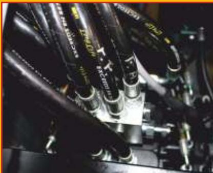
Die ELX-Serie nutzt eine leistungsstarke LoadSensing-Pumpe in Kombination mit einem Flowsharing-Ventil. Dieses hocheffiziente Hydrauliksystem stellt Hydraulikleistung nur dann zur Verfügung, wenn sie gebraucht wird. Das Ergebnis ist maximale Energieeffizienz. Ein kluges Design, das Ressourcen spart und die Umwelt schont!
