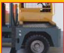
Die Plattform, auch der Tisch des Seitenstaplers genannt, ist serienmäßig mit einer Mehrschicht-Siebdruckplatte abgedeckt. Für Anwendungen in der Stahlbranche gibt es optional Abdeckungen aus Riffelblech. U-Profilen mit Hartholzeinlagen oder vorgeformte Holz- und Metallprofile auf der Plattform, dienen als Transportlager für Stahl- und Kunststoffrohre.
