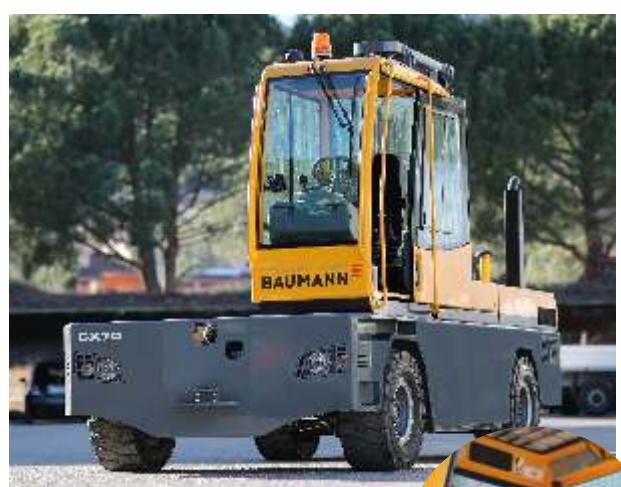
Neben unterschiedlichen Kabinenbreiten ist optional eine um 500 mm erhöhte Kabinenposition lieferbar. Auch die um 180° drehbare Panoramakabine sowie diverse Kamerasysteme sind Ausstattungsoptionen die helfen, die Arbeitssicherheit zu erhöhen.
