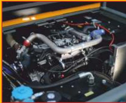
Die HX-Serie verfügt über einen leistungsstarken, hoeffizienten Dieselmotor aus dem Hause HATZ. Der 2,0l Stufe V – Motor hat eine Leistung von 55 kW und ist mit einem Dieselpartikelfilter (DPF) und einem Dieseloxidationskat (DOC) ausgerüstet. Die Zugabe von AdBlue ist nicht nötig.
