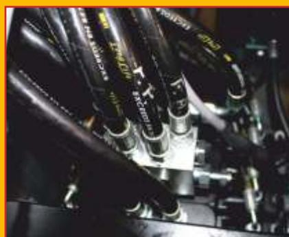
Die Arbeitshydraulik der HX-Serie wird von einer leistungsstarken LoadSensing Pumpe gespeist. Dies ermöglicht mehrere Hydraulikfunktionen parallel abzurufen. Der hydraulisch vorgesteuerte Joystick erlaubt dem Bediener, präzise und millimetergenau zu arbeiten. Dieses hoeffiziente Hydrauliksystem stellt Leistung nur dann zur Verfügung, wenn sie gebraucht wird. Das Ergebnis ist ein reduzierter Kraftstoffverbrauch. Ein kluges Design, das Ressourcen spart und die Umwelt schont!
